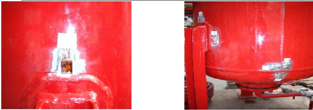
Figura 7.26. Lipirea mărcilor tensometrice
