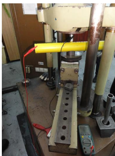
Fig.4.4. Detaliu ansamblului de determinare a rezistenței izolației
