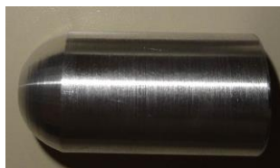
Fig.4.3. Dorn realizat din dur aluminiu
