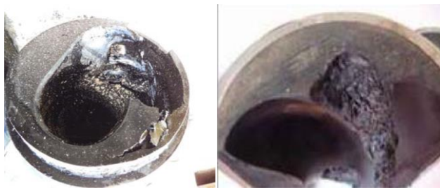
Fig. e- ruperea și tasarea elastomerului, Fig. k- distrugerea elastomerului datorită temperaturilor mari
