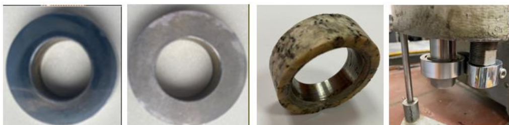
Fig.3.19. Epruvete: role cromate, nitrurate și din granit, cauciuc SKN, Z13 și poliamidă PA6.6
