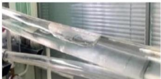
Figura 3. Curgerea structurală a fluxului gaz-lichid în secțiunea descendentă a conductei.
