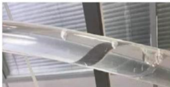
Figura 2. Curgerea structurală a fluxului gaz-lichid în secțiunea ascendentă a conductei.
