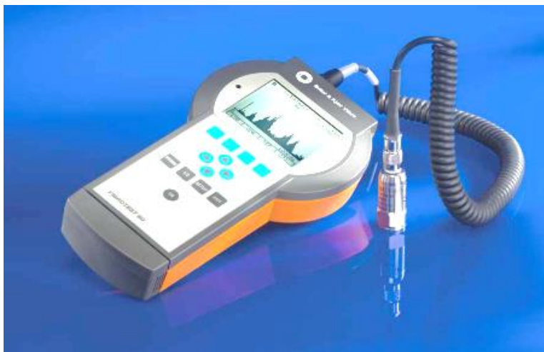
Fig. 3.93. Echipament de detecție, model Vibrotest 60 echipat cu traductor de accelerație model AS 065.
