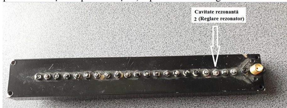
Fig. 4.31 – Filtrul parte a procesului cu evidențierea șurubului aferent cavității asupra căruia s-a intervenit în cadrul testului T_1 .
