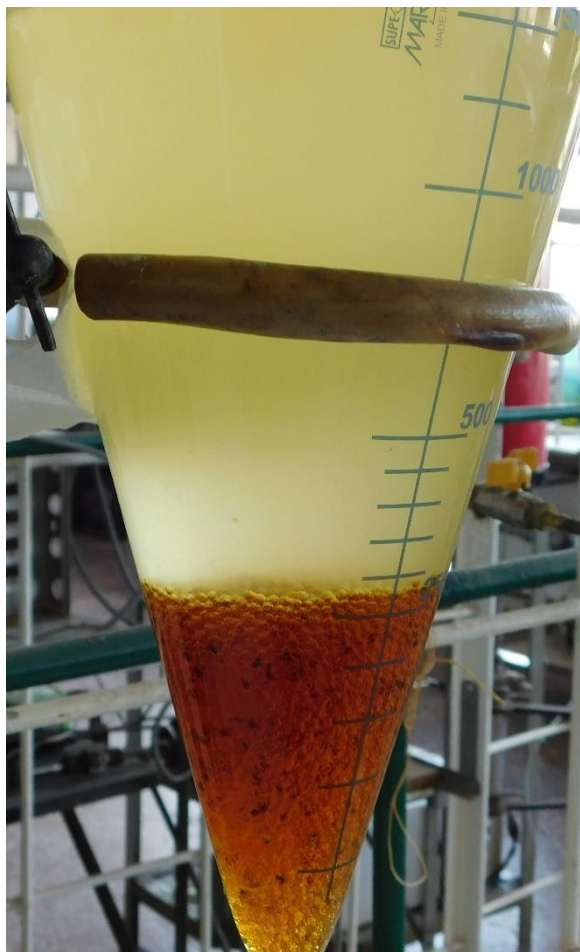
Figura 3.6 Uscare pe silicagel
