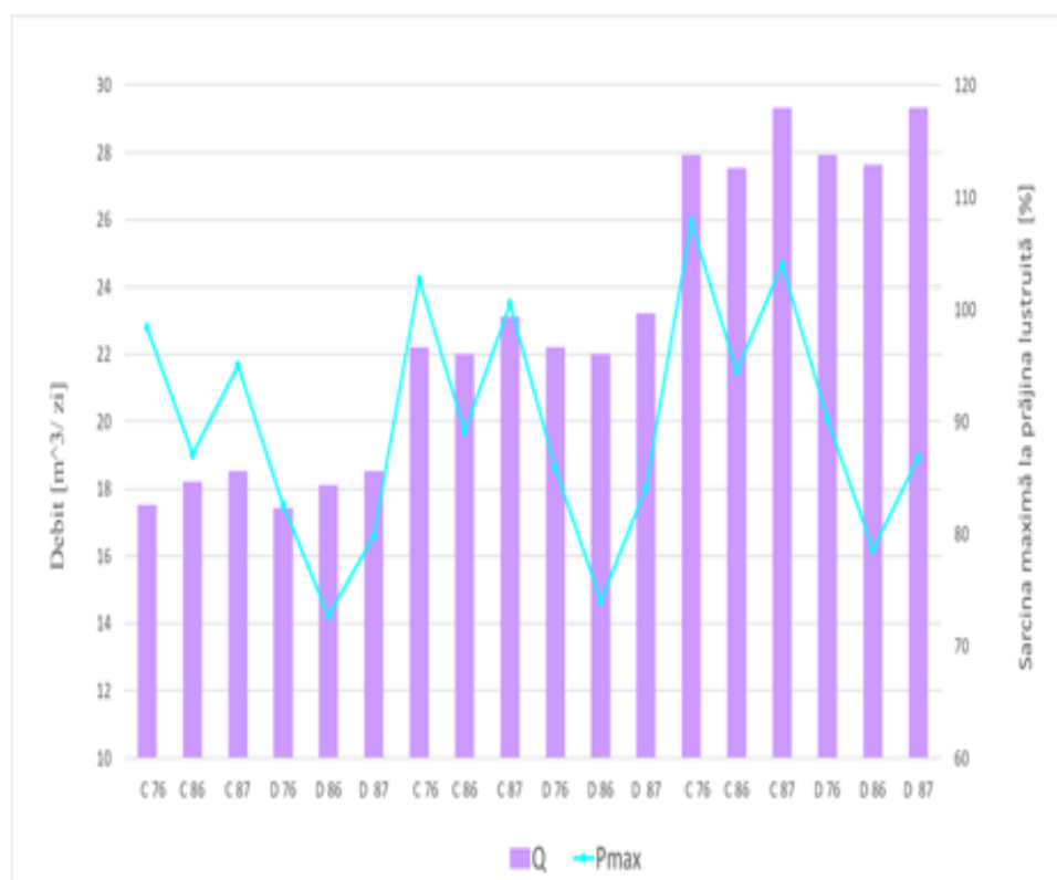
Fig. 15. Variația debitului în funcție de sarcina maximă prăjina lustruită pentru tipul prăjinii de pompare
