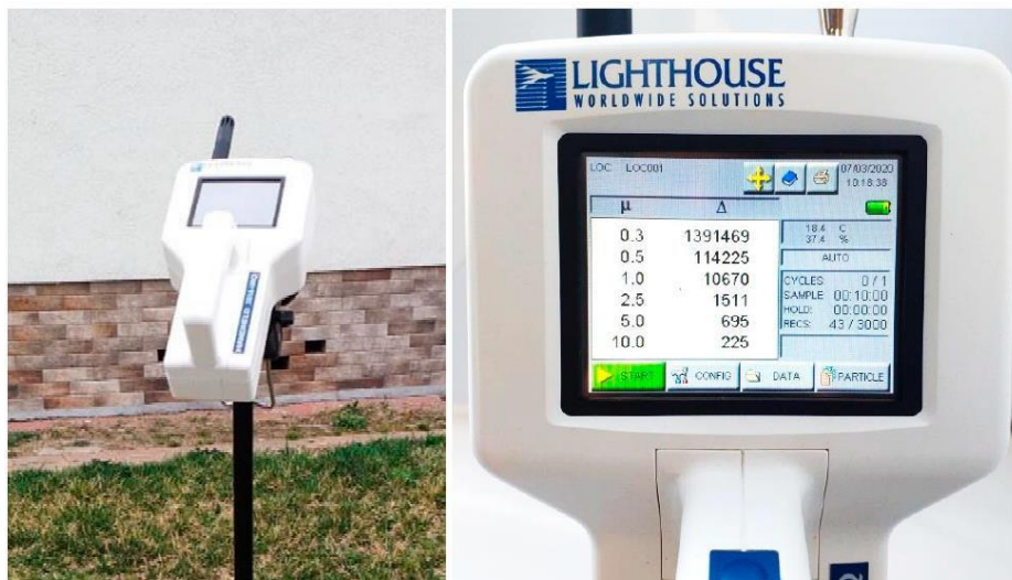
Figura 4.7. Numărătorul de particule Lighthouse 3016 IQ în funcțiune
