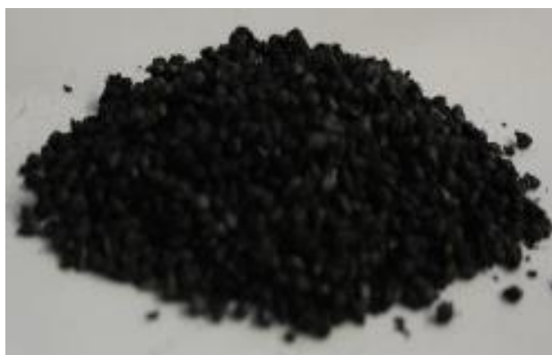
Figura 6.3. Biocărbune rezultat din sâmburi de struguri în prezență de acid fosforic
