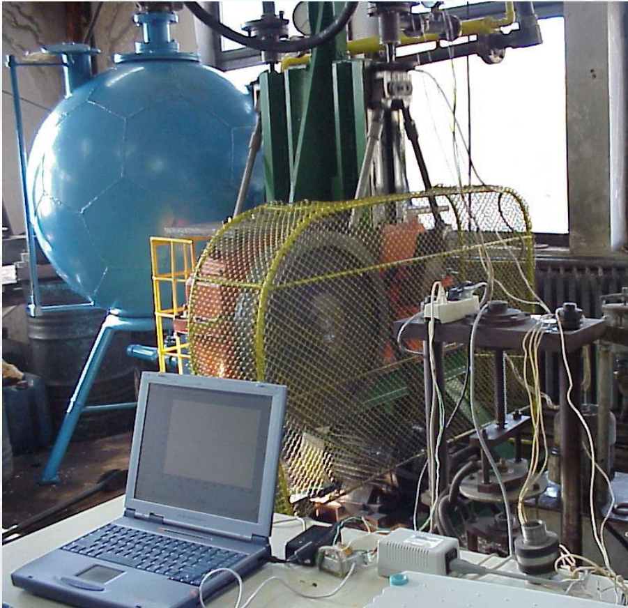
Vedere de ansamblu a instalației experimentale pentru încercarea pompelor de extracție
