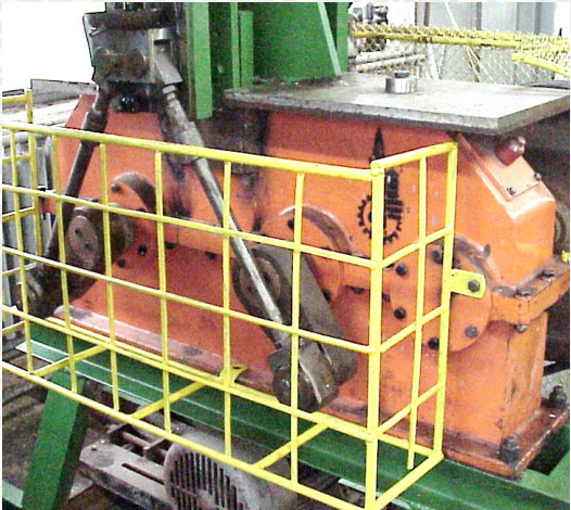
Mecanismul de acționare a pistoanelor de pompă
