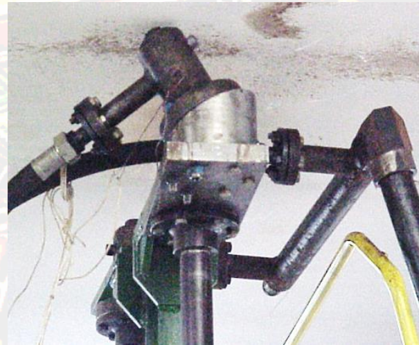
Amplasarea ansamblului colivie-supapă cu bilă echipat cu un traductor inductiv de deplasare, pe instalația experimentală: a. unghiul de înclinare 0^\circ ; b. unghiul de înclinare 10^\circ ; c. unghi de înclinare 20^\circ ; d. unghiul de înclinare 30^\circ
