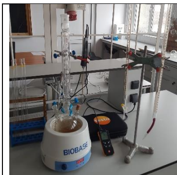
Figura 1. Sistem de reacție la temperaturi înalte cu monitorizare electronică a temperaturii
